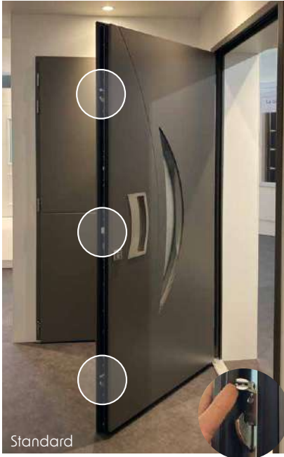
SERRURE MULTIPOINT Automatique avec 5 points de fermetures : 2 crochets, 2 pènes ronds et un pêne dormant
